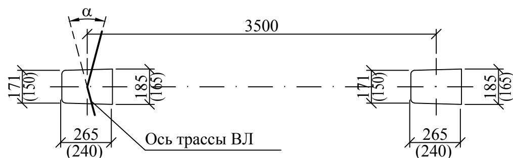
Схема установки стойки СВ95-3 (СВ95-3с)
