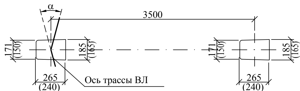
Схема установки стойки СВ95-3 (СВ95-3с)
